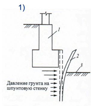
1) Смещение шпунта в сторону котлована
